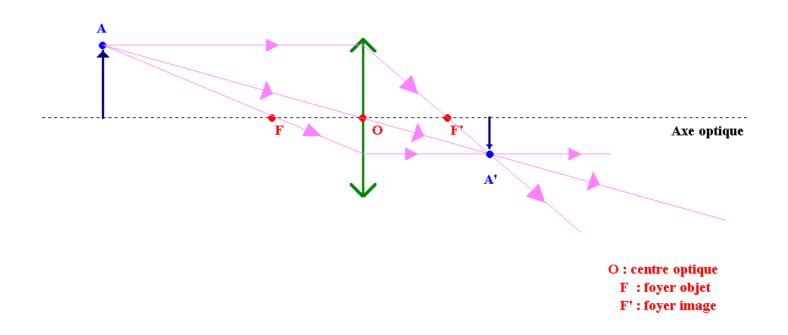
Les trois rayons lumineux se coupent en un point A', qui est l'**image de** A. On peut donc tracer l'image de la flèche, en partant de l'axe optique et en arrêtant au point A'. Nous constatons sur cet exemple que l'image de l'objet est inversée haut/bas et est plus petite que l'original.
