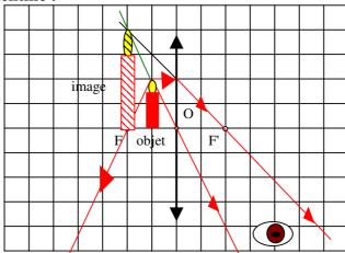
Si on regarde à travers la lentille, on observe une image virtuelle agrandie et droite de l'objet : on utilise la lentille comme une loupe.
