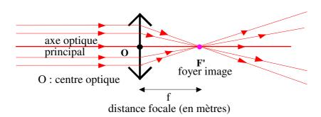
La distance focale (f en mètres) c'est la distance séparant le foyer image (F') du centre optique (O).
