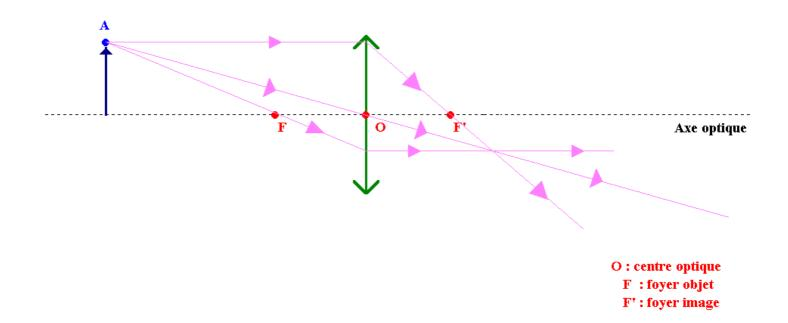
Le troisième rayon part toujours de A et passe par le **foyer objet** (**F**). Lorsqu'il ressort de la lentille, il est parallèle à l'axe optique.
